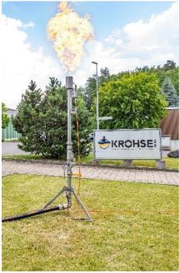
Restgasmengen sollten zwingend aus dem Bereich einer gesperrten, stillgelegten oder mit neuem Medium befüllten Versorgungsleitung entfernt werden. Für eine umweltbewusste Unternehmensphilosophie sollten diese abgefackelt werden, um so Methanemissionen zu vermeiden.
