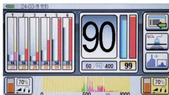
Der Pyramidenmodus ermittelt im Hintergrund mit intelligenten Algorithmen und Rechenverfahren automatisch die optimale Leckanzeige und ermöglicht dadurch eine bis dato unerreichte Feinpositionierung der Leckstelle. So können mittels diesen innovativen und einzigartigen Messverfahren und ultimativer Chebyshev Analogfilter mit 48 dB / Oktave Steilheit, Störgeräusche hörbar besser eliminiert werden.
