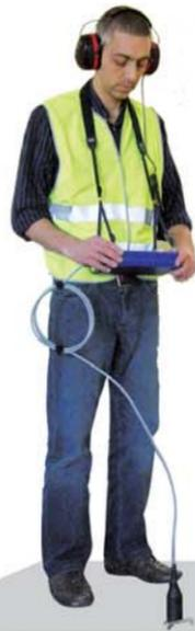
Die klare, übersichtliche und farbige Darstellung unterstützt den Anwender bei der Lecksuche. Dabei sorgen 256 automatische und manuelle Filtereinstellungen für die bestmögliche Störgeräuschunterdrückung und somit für ein eindeutiges Ergebnis. Mittels der automatischen Ansteuerung der Verstärkung und Filtereinstellung werden selbst kleinste Leckagen eindeutig erkannt und angezeigt.
