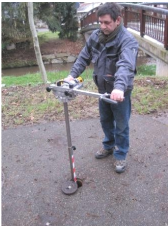
1. Ergonomische Ein Mann/Frau Griffhaltung bis 250 Nm CE u. BG konform
