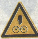
Detail-Nr. 3040 Verletzungsgefahr durch Einzug
