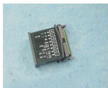
1. Demontierter Zähler inkl. Batterie innerhalb des Zählers
