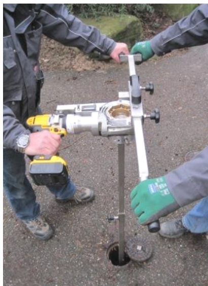
2. ... oder zwei Personen Griffhaltung bis 500 Nm CE u. BG konform
