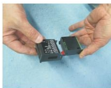
2. Gehäuse von Innenteil abziehen
