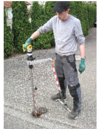
4... oder am sichersten und bequemsten mit dem leichten aufsteckbaren VA Fußstützgestell (bis 400 Nm CE u. BG konform oder 600 Nm)
