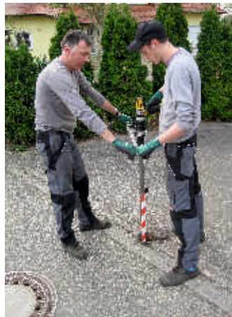
2. ... oder zwei Personen Griffhaltung bis 400 Nm CE u. BG konform
