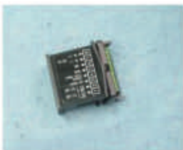
1. Demontierter Zähler inkl. Batterie innerhalb des Zählers
