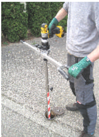
1. Ergonomische Ein Mann/Frau Griffhaltung bis 250 Nm CE u. BG konform
