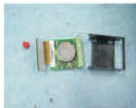
3. Zerlegter Zähler mit Knopfzellenbatterie fest verlötet an Platine
