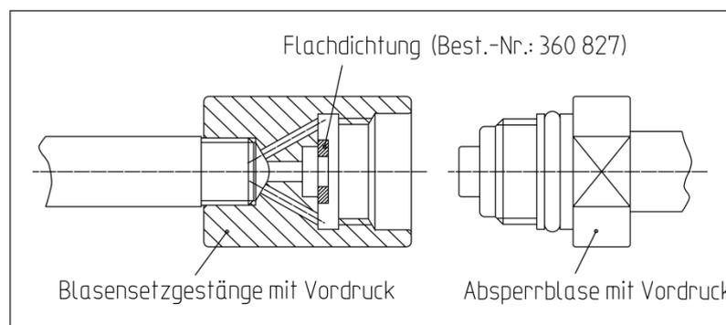
**HINWEIS** : Ein Einkleben, einer im Außendurchmesser kleineren Flachdichtung erweist sich als problematisch, weil ein Verkleben der kleinen Vordrucköffnung im Gestänge geschehen kann. Damit wäre eine Vordruckmessung nicht mehr möglich.
