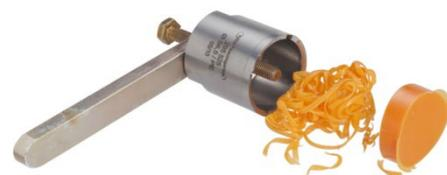
Bei Stahlanbohrungen wird zuerst der Zentrierbohrer herausgeschraubt, um die Bohrplatine zu entfernen.
