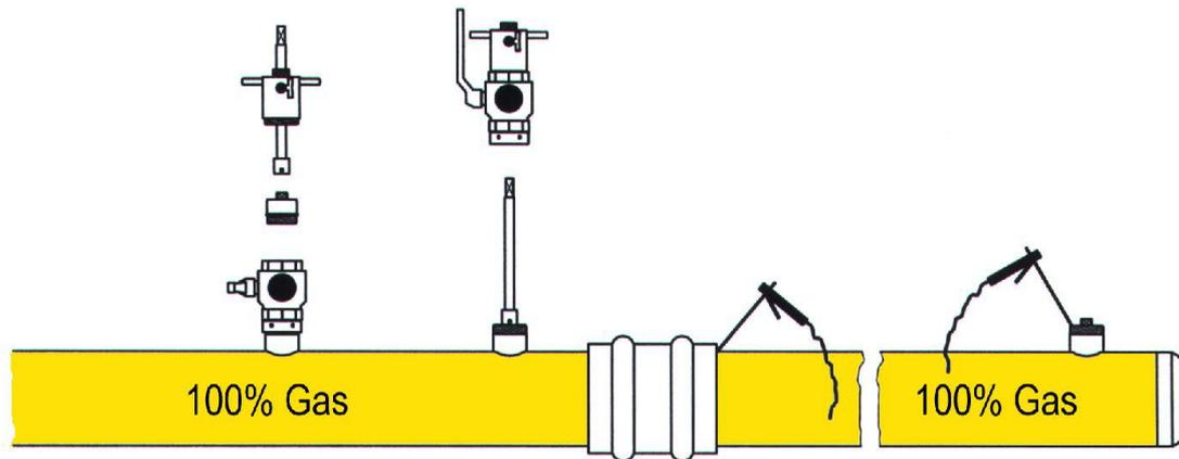
**HINWEIS** : Bei Stopfen mit Außenvierkant wird die komplette Schleuse von der Muffe abgedreht und über die Stopfensetzstange abgezogen. Die Innensechskantschrauben lösen und die Stopfensetzstange von dem Stopfen herunter nehmen.
