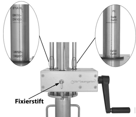
**HINWEIS** : Die entsprechende Kennzeichnung befindet sich bei korrekter Einfahrtiefe direkt über dem Getriebekasten!
