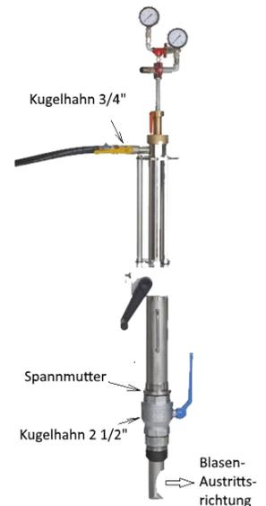
Damit die Blase beim Einsatz im Gerät problemlos von der Senkrechten in die Rohrachse umlenkt, muß die Base vorgebogen werden. Die **MDS-Blase** wird im Schlauchbereich (Bereich a) und im Teleskoprohrbereich (Bereich x) vorgebogen, so dass die Blase eine Vorbiegung von 90° erhält (vorbiegen und nicht knicken).
