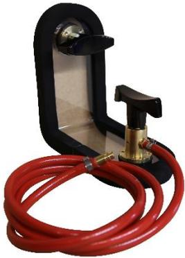
Unsere Vakuumprüftechnik eignet sich zur Dichtheitsprüfung von Schweissnähten an Stahlrohrleitungen, Tanks und Behältern. Bedenkenlos sind diese Produkte auch für den Trinkwasser- und Lebensmittelbereich einsetzbar dank ölfreier Vakuumpumpen.
