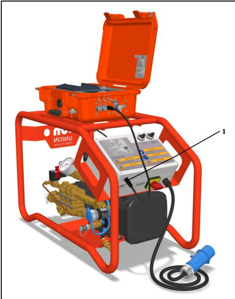
Abb. 7.2: Anschluss Dichtheitsprüfkoffer "PMS"
